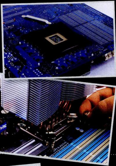
Spony pro platformu AMD slouží k uchycení na standardní plastový rámeček kolem patice. Při nasazování spon musíte pamatovat na to, že se na stranu s ventilátorem montuje spona s krátkým očkem. Na sponu s delší úchytkou na opačné straně je potom při upevňování chladiče zapotřebí pořádně přitlačit. Orientace chladiče závisí na orientaci plastového rámečku
