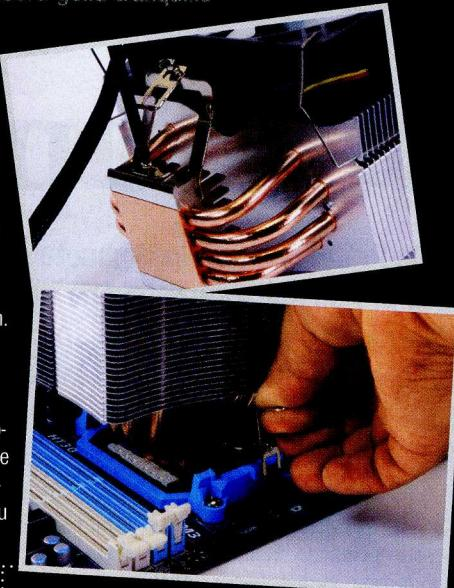
Ventilátor je uchycený pomocí drátěných spon. Při montáži mimo skříň je dobré upevnit jej ještě před osazením desky do skříně, jinak vás čeká nepříjemný zápas s tuhými sponami v těsném prostoru
