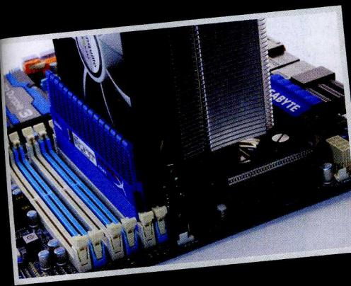
U platformy Intel se dá Tranquillo otočit vodorovně nebo svisle. V obou případech ale bude podobně jako jiné velké chladiče na většině moderních desek kolidovat s paměťovými sloty, které jsou nejblíže k patici. Pod žebrování a ventilátor se pak vejde jen nízké moduly
