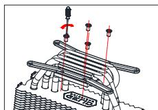
1) 将Intel™扣具用M3x5的平头螺丝固定在散热器上面。
