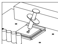
3) 将GC-Pro导热膏均匀的涂在CPU的表面。
