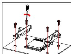
2) 如果背板上面没有装好塑胶扣和螺钉就按图中的方式装好螺钉，将螺丝钉移到相对应的孔位中。
