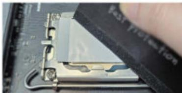
3. Legen Sie es auf die CPU-Oberseite (Intel) oder die Kontaktfläche des Kühlers (AMD), wischen Sie das HeatPhase Ultra mit der Kante einer Karte (z. B. Kreditkarte) ab und warten Sie 3 Minuten.
