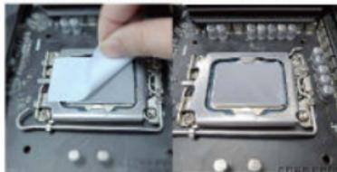
4. Entfernen Sie die transparente Folie vorsichtig und lassen Sie das HeatPhase Ultra auf der Oberseite der CPU. Installieren Sie dann den Kühler.
