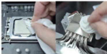
1. Reinigen Sie die Oberseite der CPU und die Kontaktfläche des Kühlers mit Alkohol.
